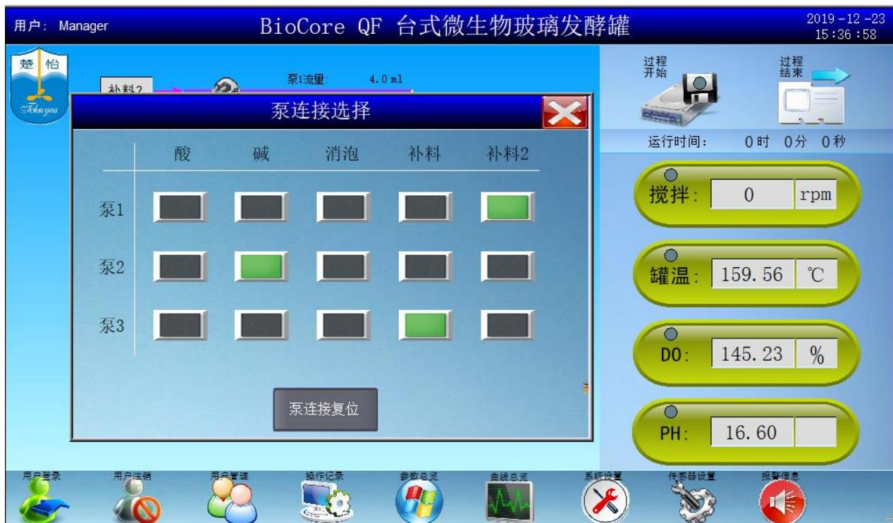
选择完泵后，相应泵功能会显示在泵的连线前面：如“酸”、“碱”、“消泡”、“补料”。如果需要重新对泵的功能进行选择，长按（2秒以上）“复位”按钮后可以进行重新选择。
