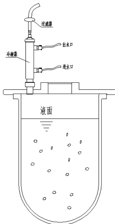
包含尾气冷凝器和过滤器，用于减少罐体内水分的损失。
