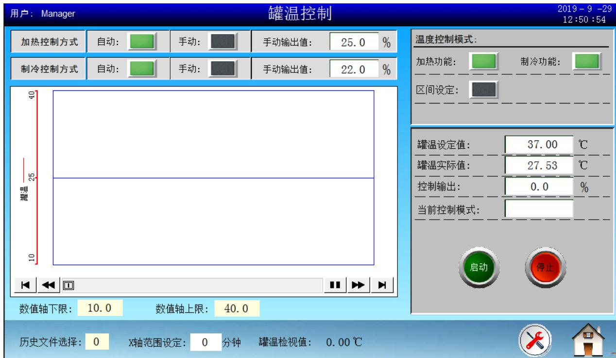
直接点击罐温设定值的数据，弹出对话窗口，可以设定罐温，点击“启动”按键后罐温进行自动控制。
