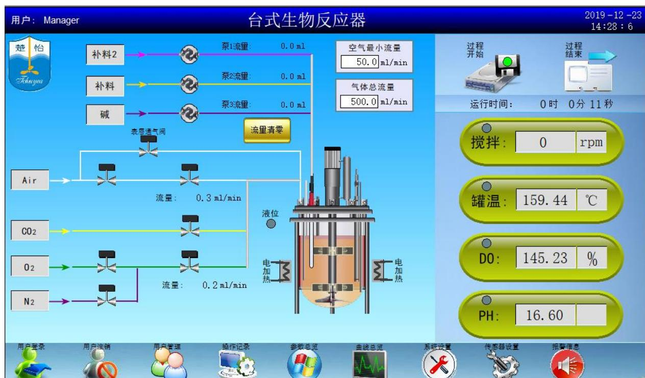
标准的气体控制顺序是：在溶氧高于设定值时，只通最小流量的空气，当溶氧低于设定值时，空气通气量逐渐增加，一直增加到气体总流量的限定值，如果此时溶氧还是不足，在保存总流量不变的情况下，氧气逐步介入，其通气比例可以有0增加至100%。
