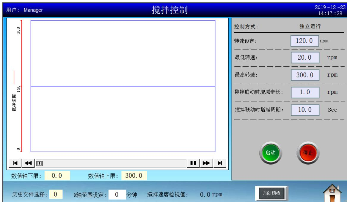
点击速度设定值的数据弹出对话窗口，可设定搅拌转速。
